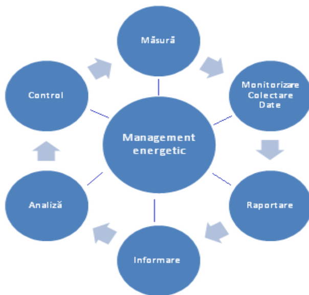
Figura 7.2.1 Componentele sistemului de management energetic
